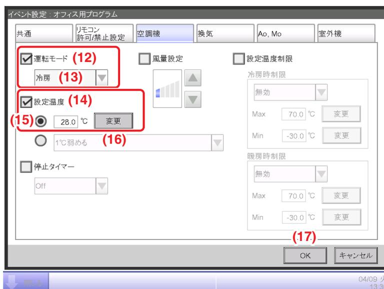
(12) 運転モードチェックボックスにチェックを入れ、コンボボックスで (13) 「冷房」を選択します。
