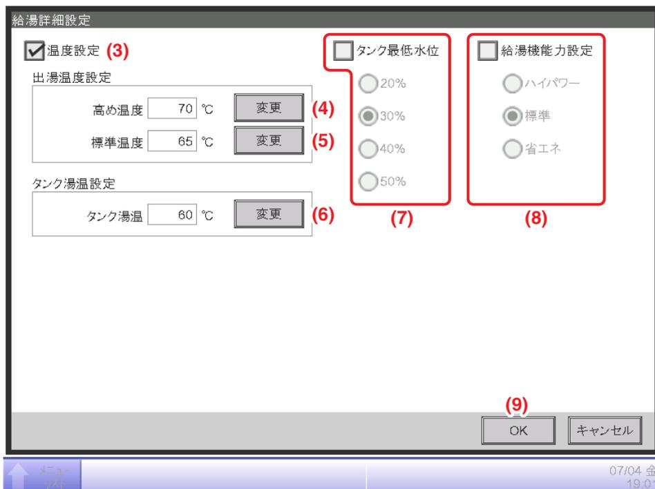
**(3)** 温度設定のチェックボックスにチェックを入れ、**(4)** 変更ボタンをタッチします。数字入力ダイアログが表示されるので、「80」を入力しOKボタンをタッチします。
