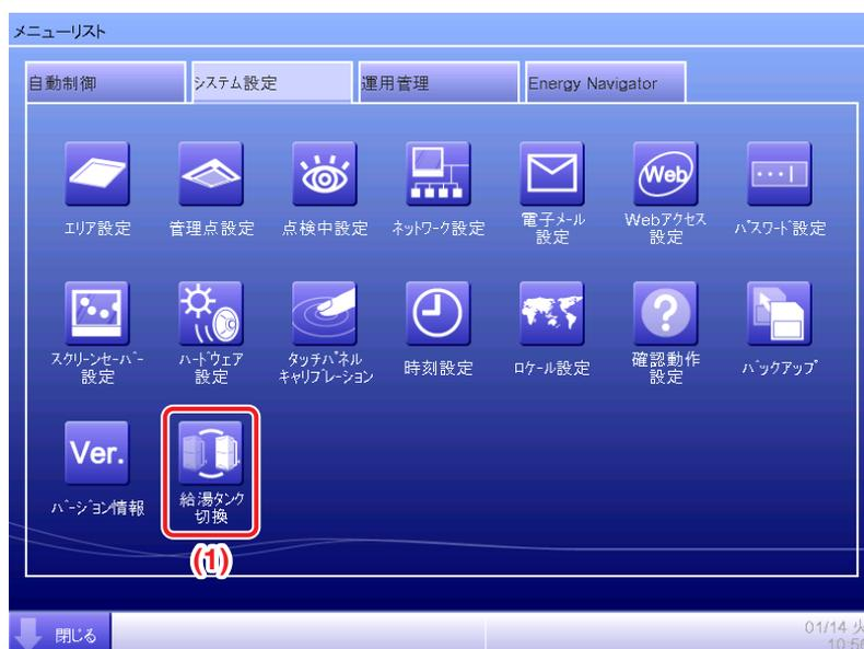
1. メニューリスト画面の**システム設定**タブで **(1) 給湯タンク切換**ボタンをタッチします。
