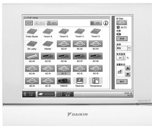
インテリジェントタッチマネージャーは、タッチコントローラーの上位システム商品として、中小規模ビルを中心に、空調システムをはじめ、施設内の様々な設備機器を一括管理し、付加価値の高い高度な設備管理を手軽に行えるコントローラーです。
