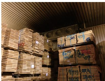
単板の原料である生材製 ナラ等を-15°Cで冷凍保管。
