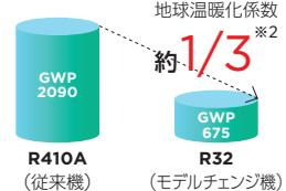
最大配管長、チャージレス長を維持しながら冷媒充填量を低減しました。
