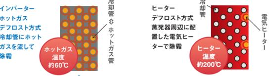
インバーターホットガスデフロスト方式なら
