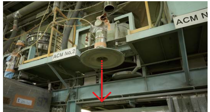
冷却された粉体塗料がここからコンテナに充填。
