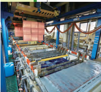
▲ブルの様な容積のメッキ槽で反応熱を抑え、液温を安定させるには高出力・高精度な熱源機が必要。
