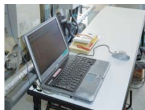
◀ 給湯使用量の1年間のデータを取るため、MEGA・Qにパソコンを接続している。
