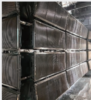
乾燥炉(触媒ヒーター)
